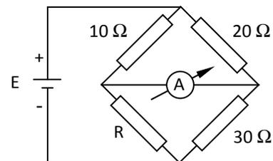
Na Ponte de Wheatstone representada na figura, a indicação do amperímetro de bobina móvel e ímã permanente será nula se R for igual a
