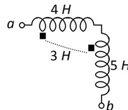
A indutância equivalente vista dos terminais a e b do circuito é
